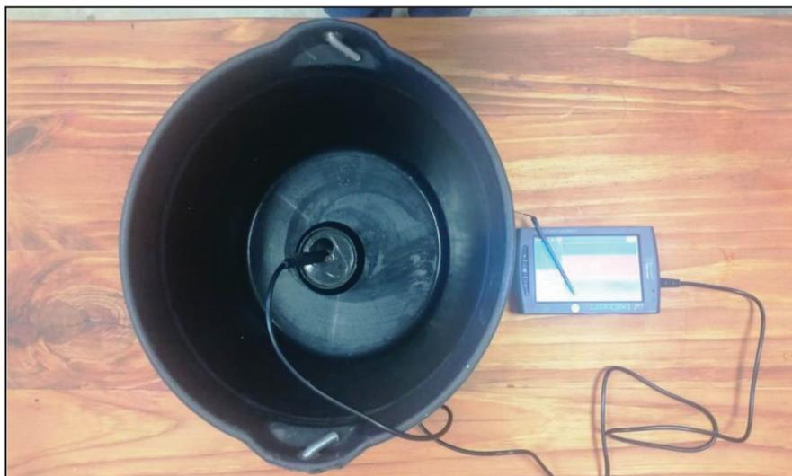
Figura 2.8 Balde contenedor de agua y recipiente con sensor de temperatura a la izquierda y a la derecha interface LabQuest2.
