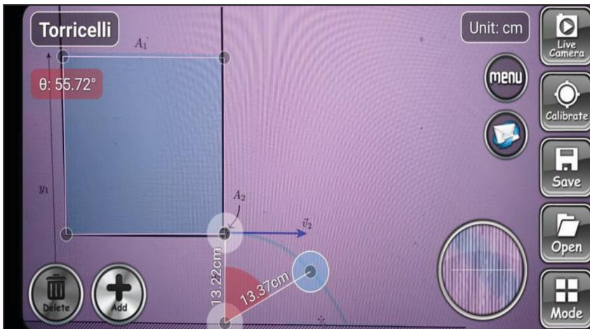
Figura 2.13. Captura de la pantalla de un teléfono inteligente al tener activa la App ON 3D- CameraMeasure que permite, mediante una referencia longitudes conocidas escalar la imagen. La App antes nombrada es de uso simple e intuitivo y puede ser obtenida desde:
