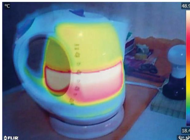
Figura 2.3 Jarra térmica calentando agua, la diferencia de colores evidencia el proceso de convección.
