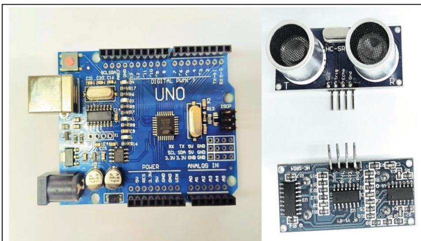
Figura 1.31 A la izquierda placa Arduino UNO y a la derecha el sensor de distancia HC-SR04
